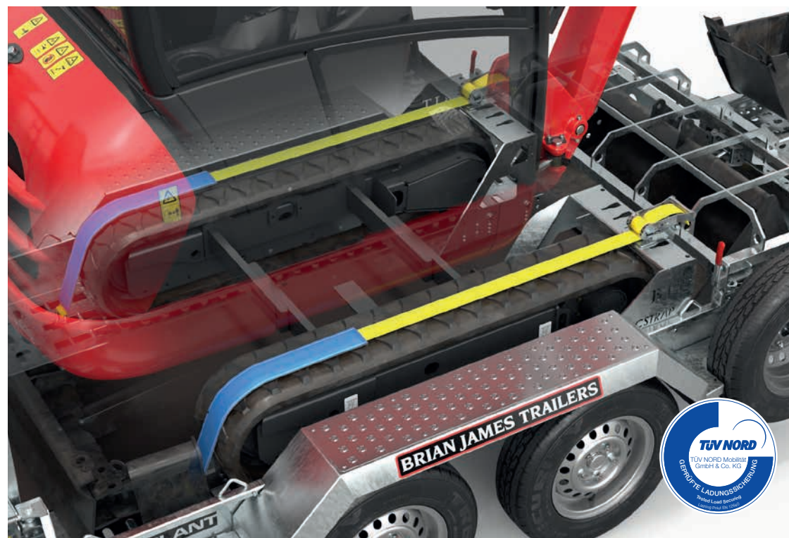
○ Extra sterk gestanst achterpaneel over de gehele breedte met veerondersteuning, geschikt voor zware machines.
